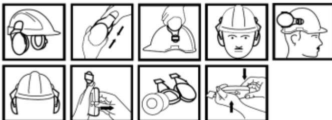
1. Antes del ajuste, inspeccione el producto para asegurarse que copas, soportes o almohadillas no estén deterioradas o dañadas. Si alguna de las partes está dañada o deteriorada, deseche inmediatamente el protector auditivo y reemplácelo por uno nuevo.
